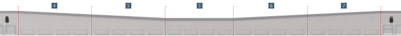
Rebaje con un 5 % de inclinación (2 piezas)
