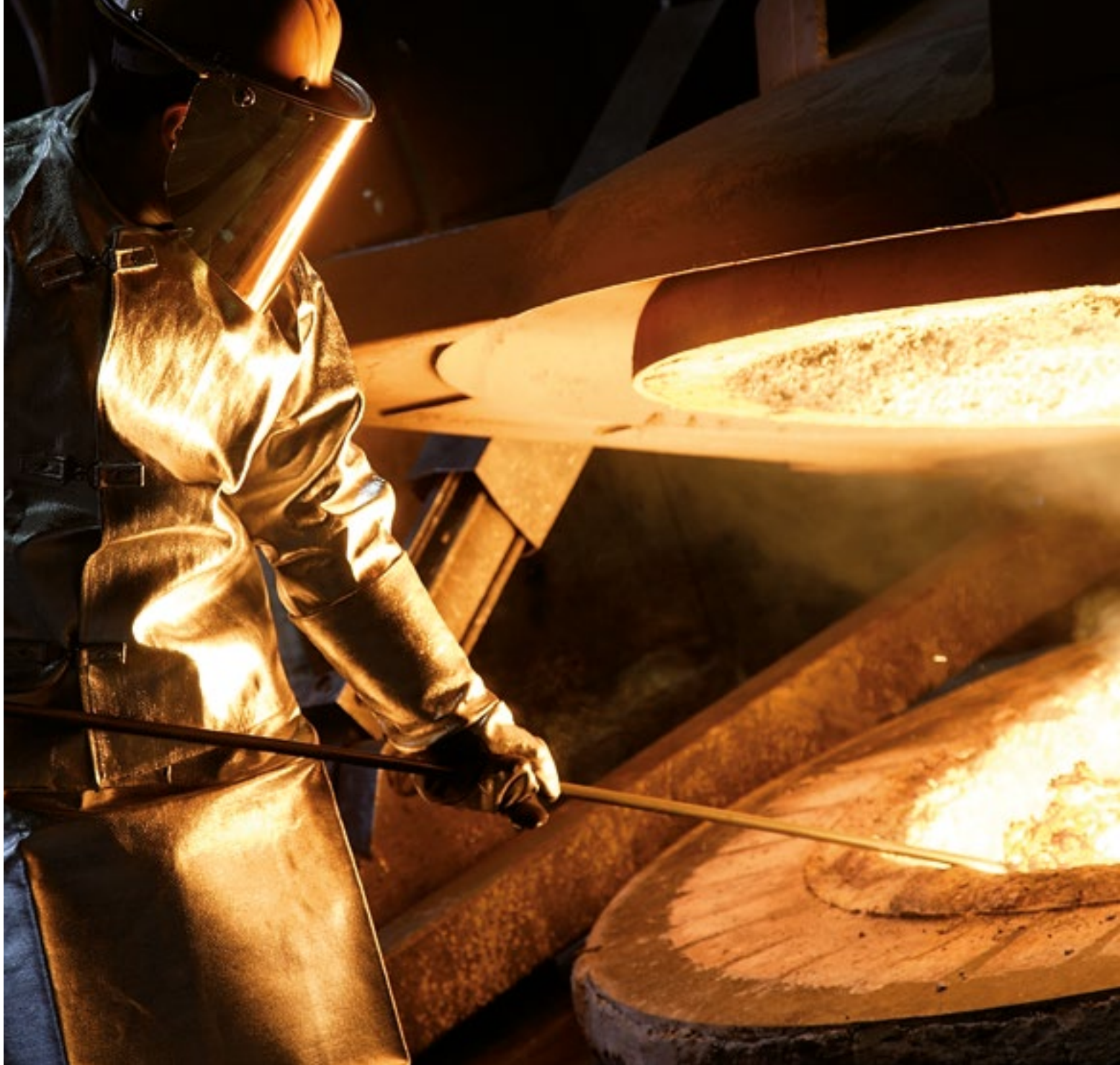
Muestreo de la masa fundida para el análisis espectral
