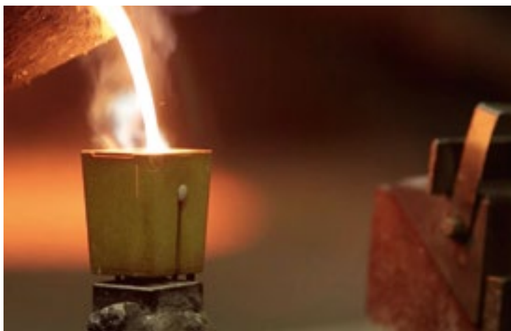
Toma de una muestra de colada para garantizar la calidad
