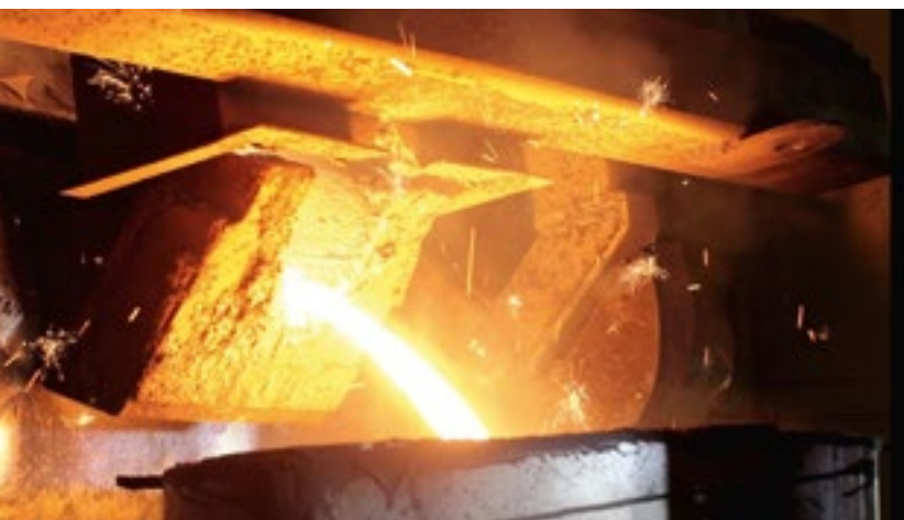
Fundición en el horno eléctrico
