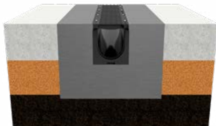
Ejemplo de instalación
