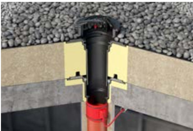
Sumidero de cubierta ACO de hierro fundido con doble clipaje mecánico
